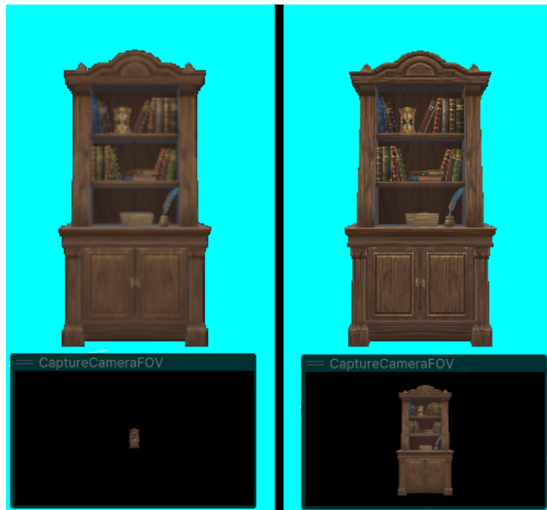
3.3. ábra. A látószög változtatás alapú módszer képélessége a vászonmérettől függően.
