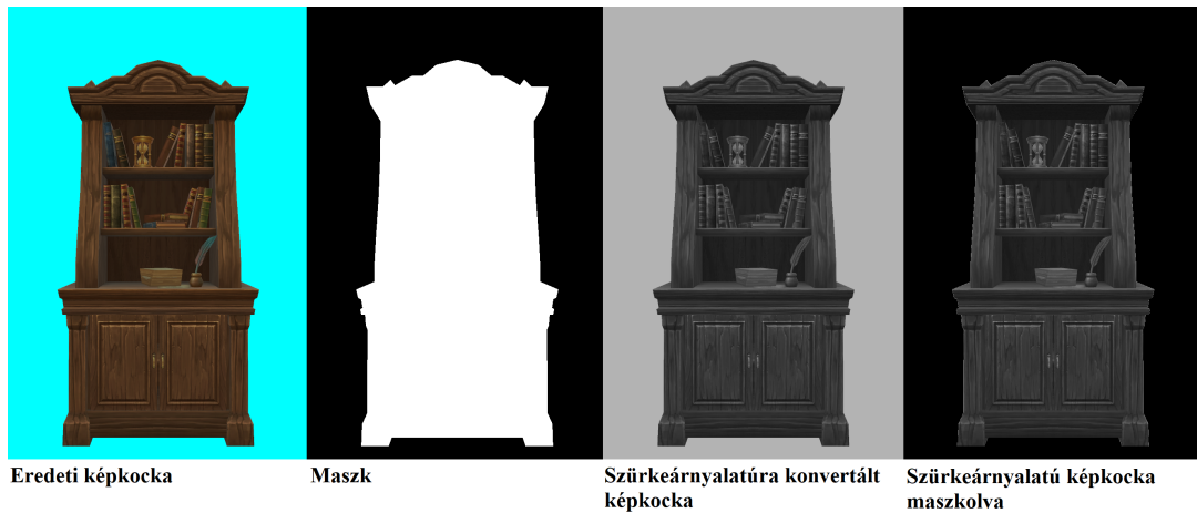
4.3. ábra. Az MSE és SSIM kiértékelést végző python szkript képfeldolgozásának 4 fázisa.
