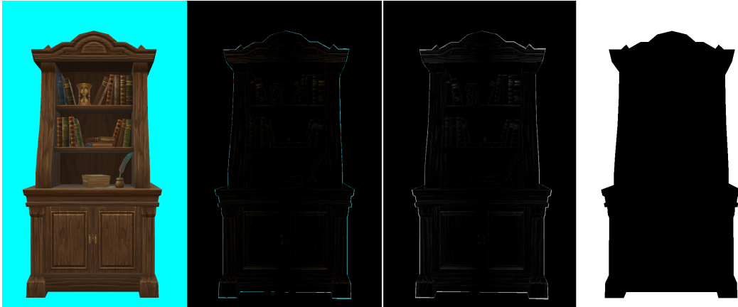
4.2. ábra. A pixel összehasonlítást végző python szkript képfeldolgozásának 4 fázisa.
