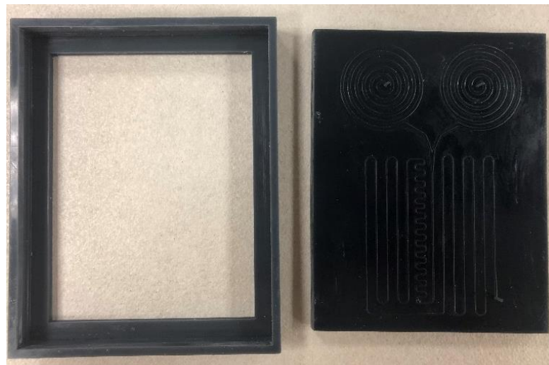
3.2. ábra Egy kész 3D nyomtatott öntőforma
