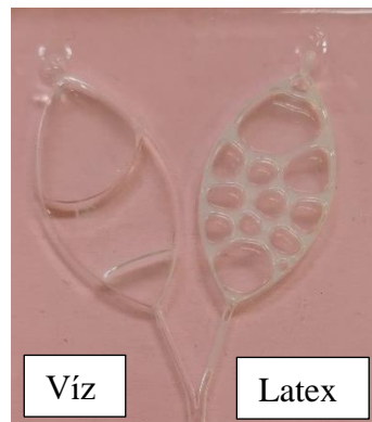
3.5. ábra A tartályokba töltött víz és latex viselkedése
