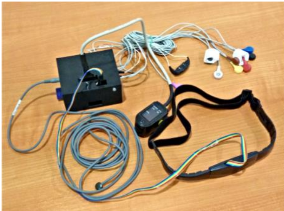
12. ábra. A Pi szenzorokkal a 3D nyomtatott dobozában
