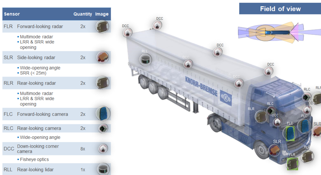
2.3. ábra. A tesztjármű szenzorrendszere [13]
