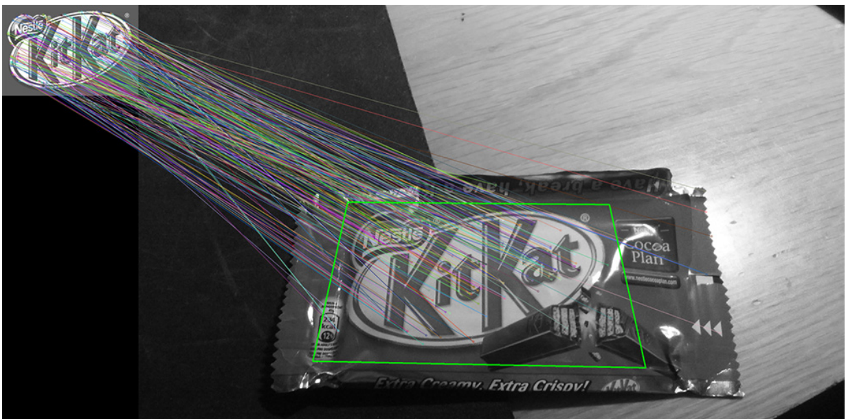
5. ábra. Jellegzetesség megfeleltetés SURF detektorral és kivonattal, FLANN megfeleltetéssel, perspektív megfeleltetés ábrázolásával.
