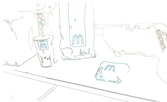
10. ábra. Canny éldetektor szemléltetése a láthatóság kedvéért inverzben
