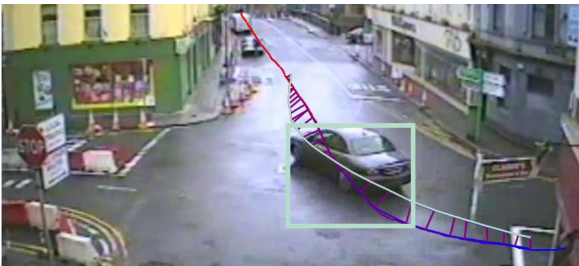
3.6. ábra. Látható, hogy bár nem teljesen illeszkedik a két görbe, de a nem is távolodik el egymástól túlságosan, és a párosításban sincsenek inverziók.
