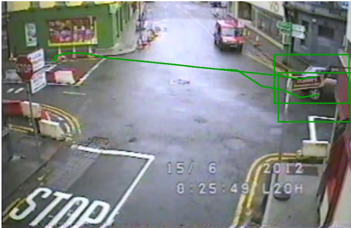
3.4. ábra. A PeakAssigner működés közben. A kép jobboldalán látható, hogy a tábla takarása miatt két külön hipotézisre (zöld téglalapok) esik szét a kereszteződést épp elhagyó jármű.
