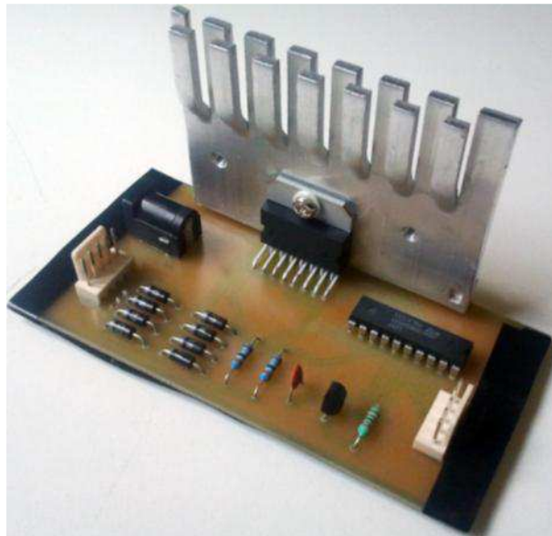
3.10. ábra: A motorvezérlő kapcsolásról készült kép.
