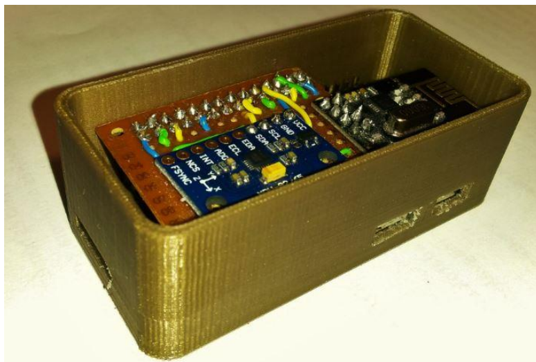
4.8 ábra Központi egységhez elkészült 3D nyomtatott tok
