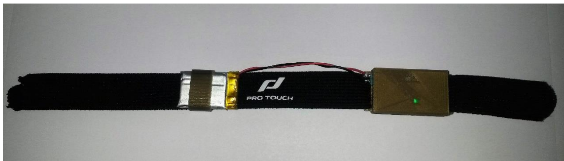
4.7 ábra Elkészült pántra rögzített akkumulátor valamint perifériális egység.
