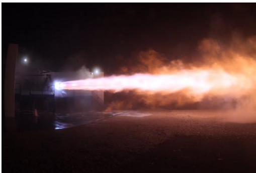
2.1.2-1. ábra. A SpaceX vállalat „Raptor” hajtóműjének tesztje
