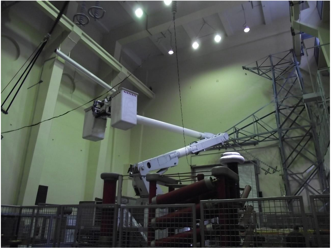
3. kép Szigetelőgémes gépjármű laboratóriumi vizsgálata
