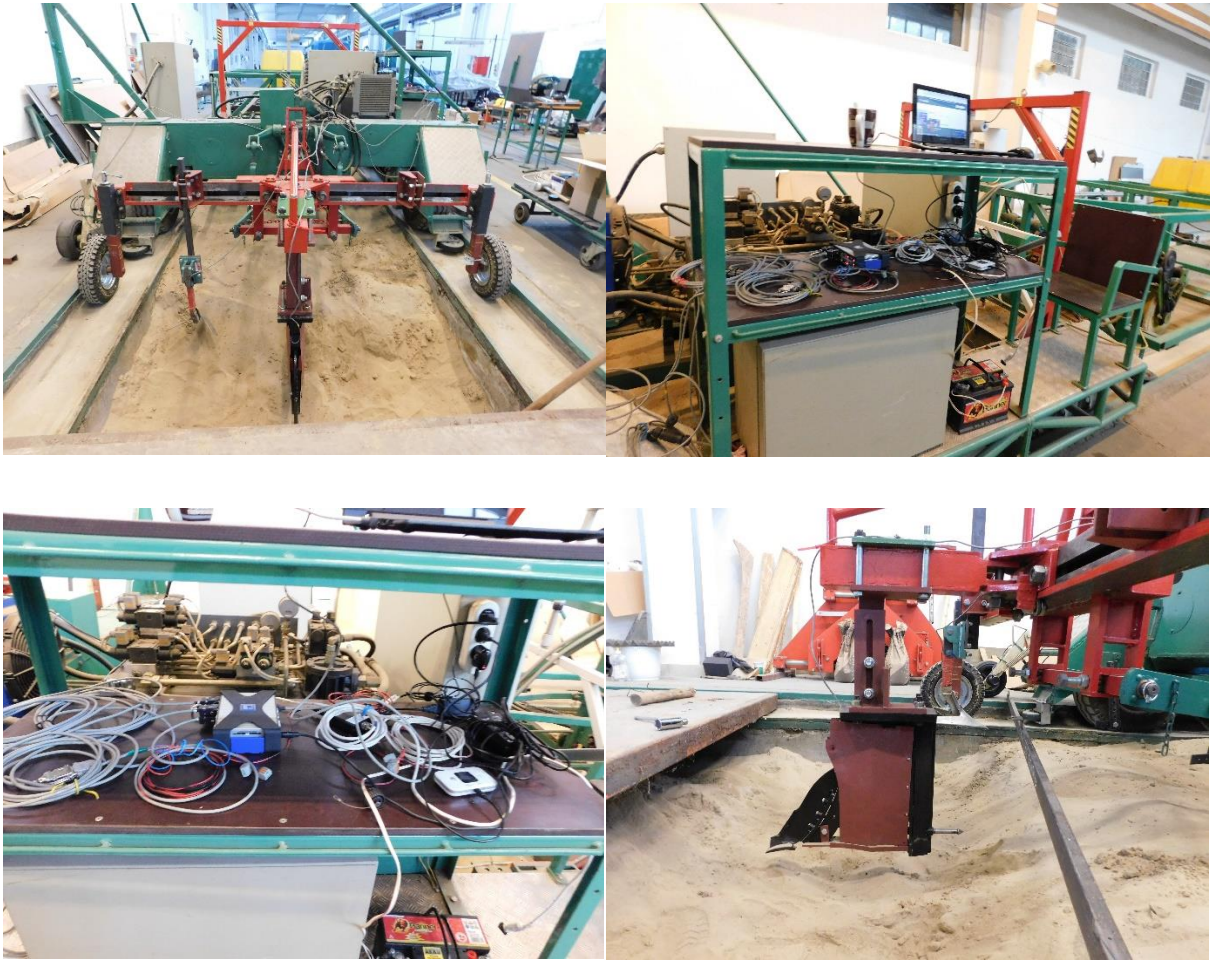
5.1 Laboratóriumi talajvályú és mérőkocsi
