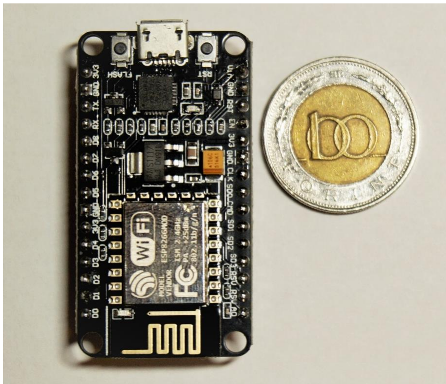
5.4 A méréshez is használt ESP8266 alapú lapka
