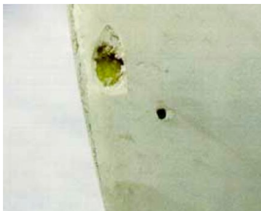
2-14. ábra - Felfogó leválás [7]
