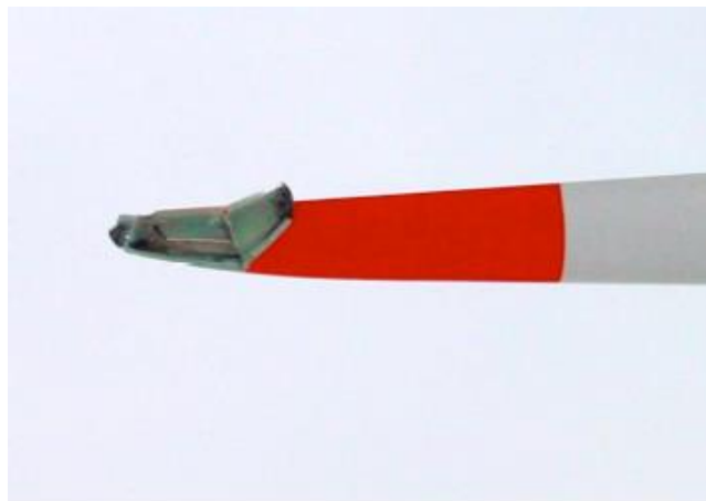
2-16. ábra - Hegesztés menti repedés következménye [7]
