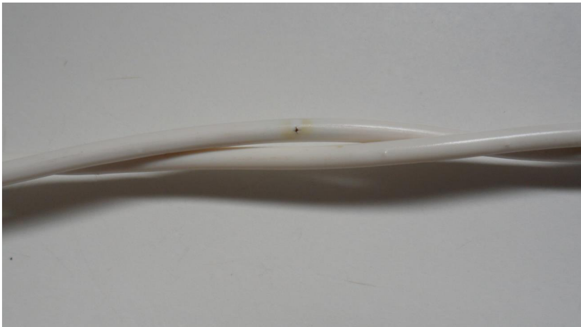
5-5. ábra – Az átütés során keletkezett sérülés
