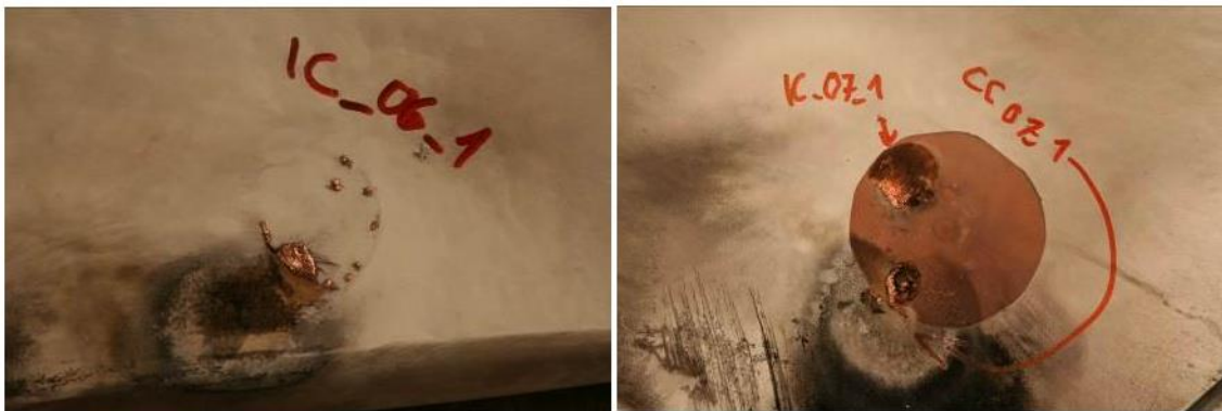
2-8. ábra - IC alatt PDR és UPDR szerzett sérülései [5]
