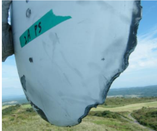
2-11. ábra - Felfogó megolvadása [7]
