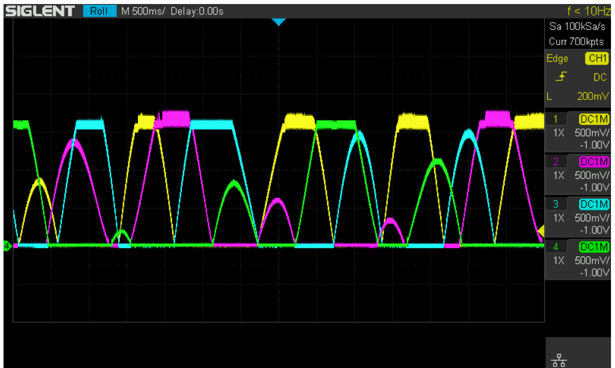
2.22. ábra. Random forgás szimulálása négy pannellel, három tengely mentén, 180mA -es áramkorláttal
