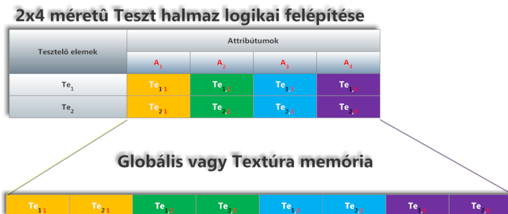
27. ÁBRA A TESZT HALMAZ TÁROLÁSA A GPU MEMÓRIÁJÁBAN
