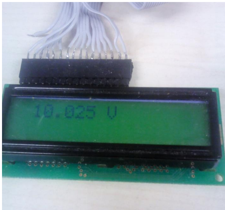
21. ábra: 10 Volt mérése és kijelzőn való megjelenítése
