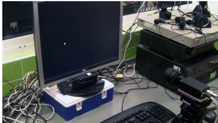
5.3. ábra. Basler kamera intrinsic kalibrálása
