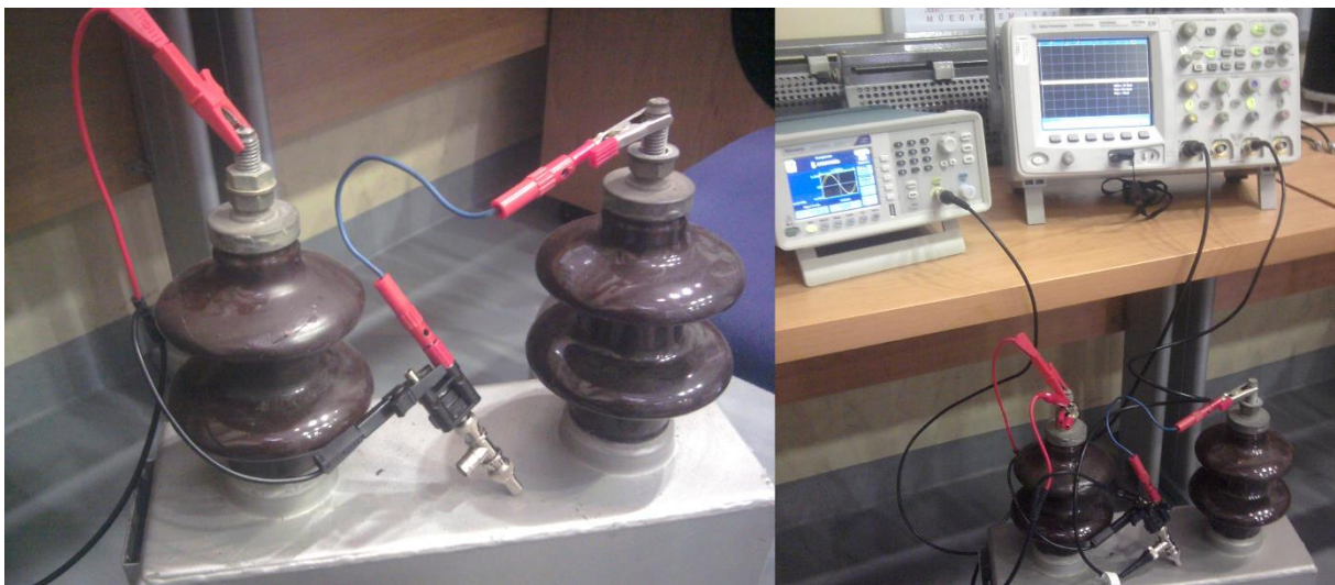
21. ábra: A kondenzátor és az ellenállás soros kapcsolása, illetve a mérési elrendezés
