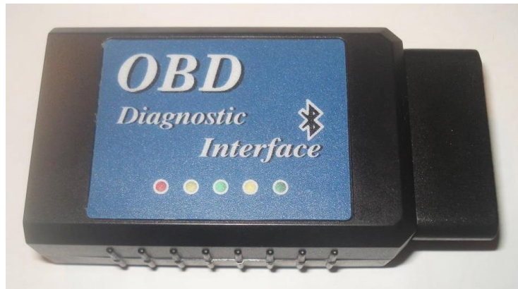
31. ábra: Bluetooth-os OBD adapter
