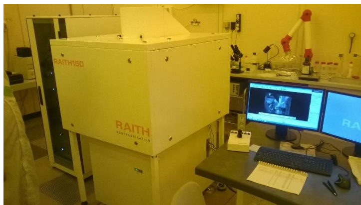
12.ábra Elektronsugaras litográf
