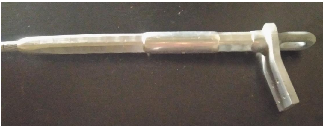
1. ábra Nagyfeszültségű sodronyon használt markolópréses feszítő
