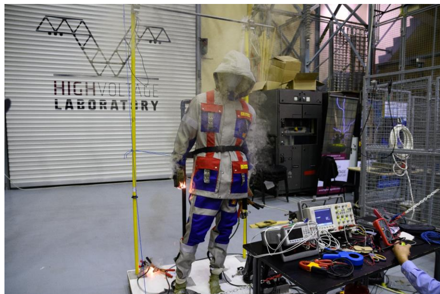
23. Ábra AC indukció elleni védőruházat laboratóriumi tesztelése [58]
