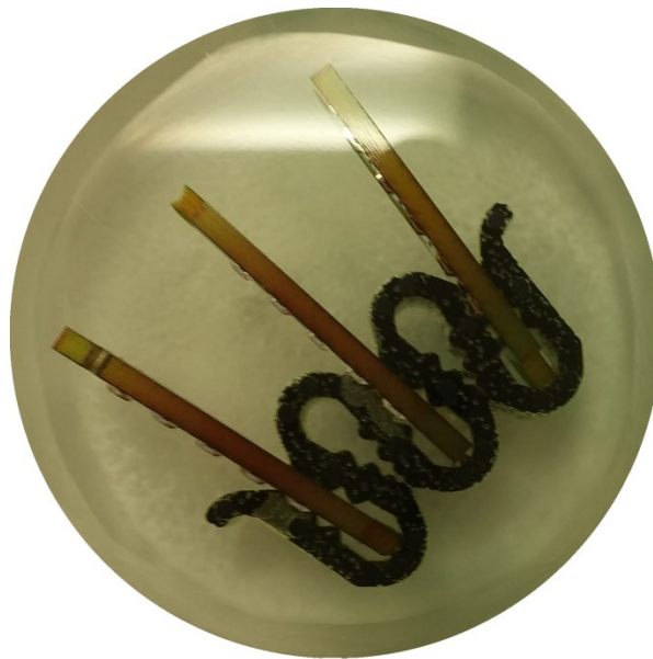
8-8. ábra – Akrillal kiöntött keresztmetszeti csiszolat
