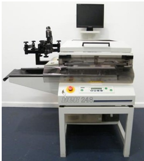
7-3. ábra – DEK 248 típusú stencilnyomtató berendezés [20]
