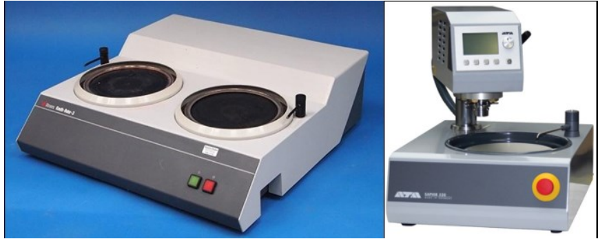
8-7. ábra – Struers Knuth Rotor 3 csiszológép (balra), ATA Saphir 520 polírozó (jobbra) [21]
