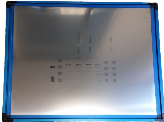
7-2. ábra – Stencilfólia egy VectorGuard feszítő keretben
