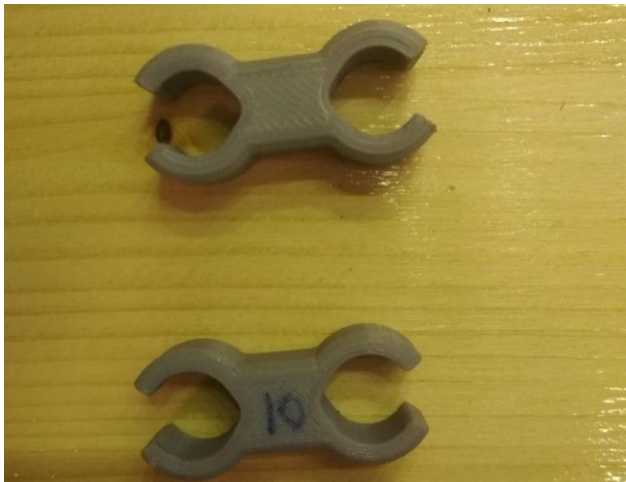
9. ábra 3D-nyomtatott távtartók az állandó távolságú méréshez
