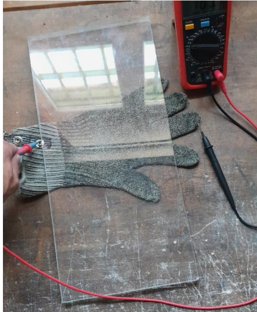
5. ábra Nyomóerő vizsgálata plexilappal
