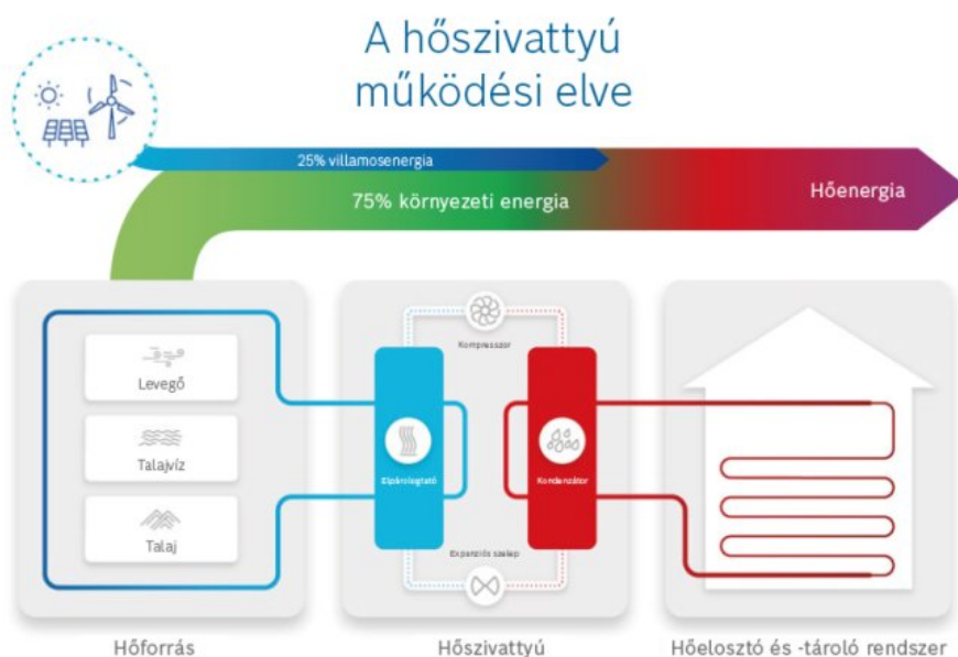
2.1. ábra. A hőszivattyú működése, hőenergia előállítása [11]
