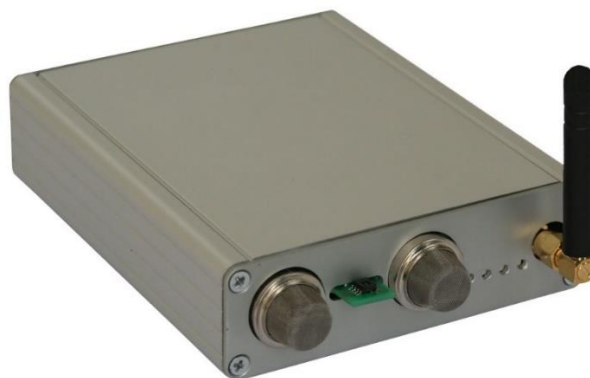
3.16. ábra: Egy kihelyezett egység már megmunkált doboza
