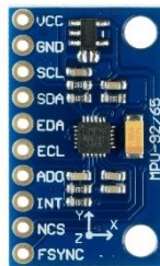
2. ábra MPU-9250, 3 tengelyes gyorsulásmérő, giroszkóp és magnetométer
