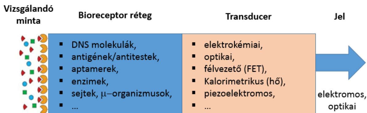
2.1. ábra Bioérzékelő sematikus felépítése [3]
