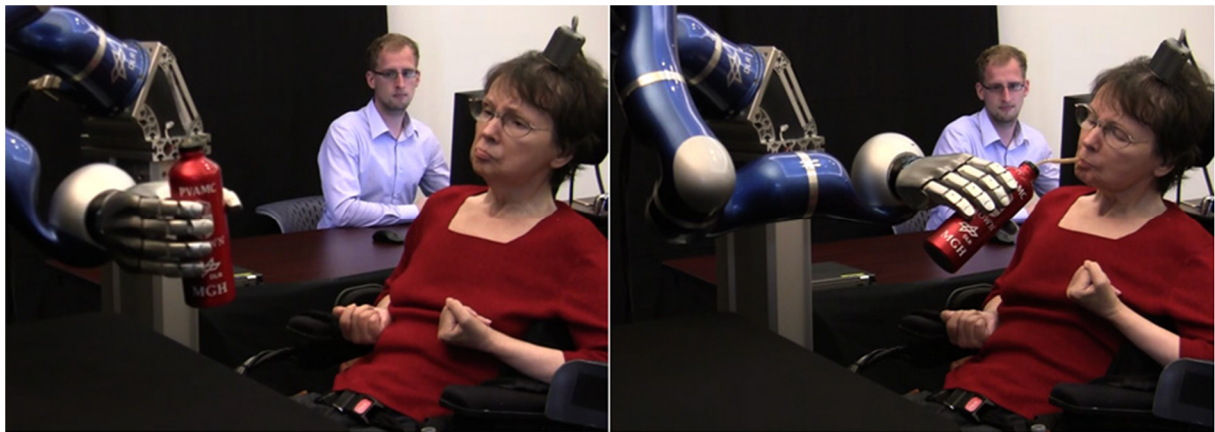
1. ÁBRA: MOZGÁSSÉRÜLT SZEMÉLY IDEGSZÖVETBE ÜLTETETT MULTIELEKTÓDRA ÉPÜLŐ AGY-GÉP INTERFÉSZ RENDSZER SEGÍTSÉGÉVEL EGY ROBOTKART VEZÉREL [18]
