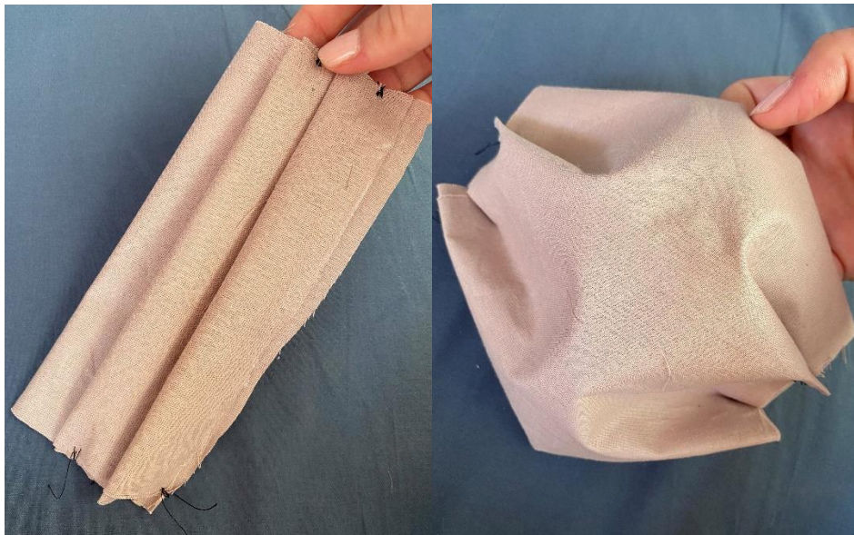
31. ábra: Szálképzéssel készült szűrőréteget tartalmazó maszk
