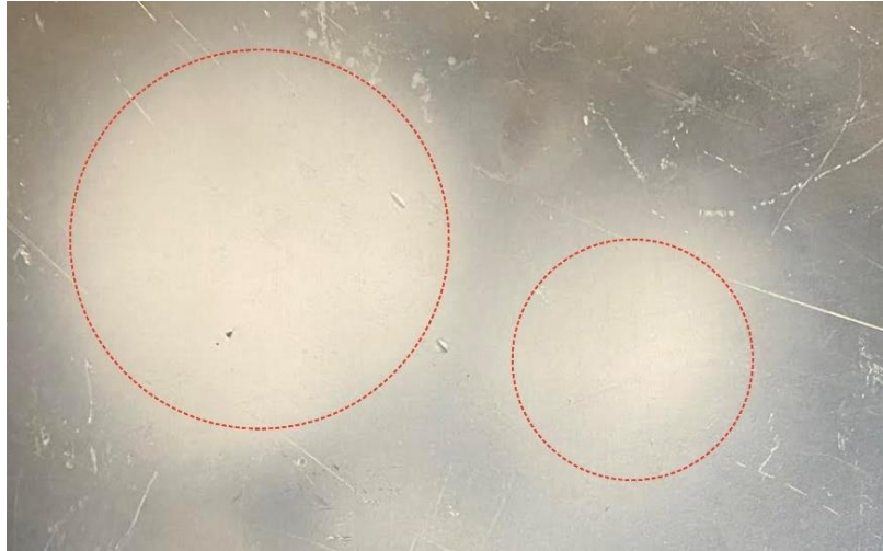
13. ábra: Szálak által lefedett terület különböző elektródtávolságok esetében
