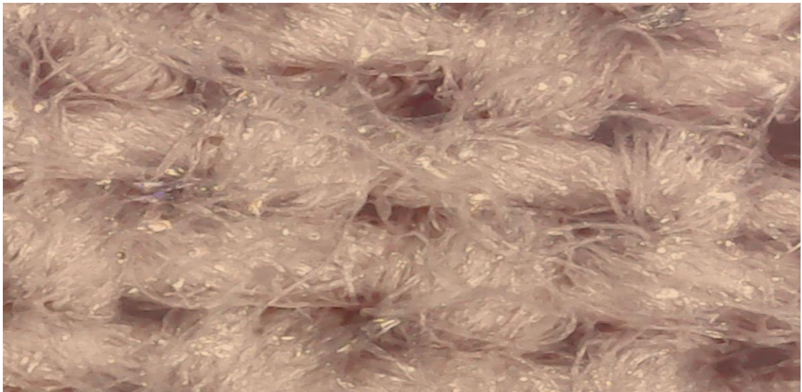
25. ábra: A mérések során alkalmazott textil szálképzett réteggel fedve
