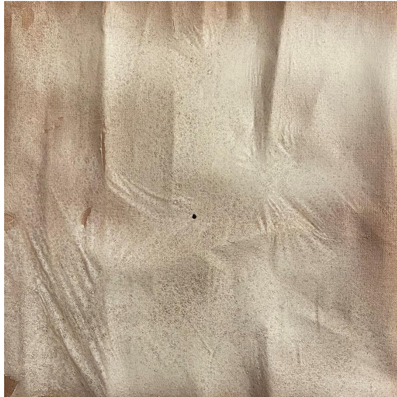
32. ábra: A szálképzett réteg állapota két napi használat után
