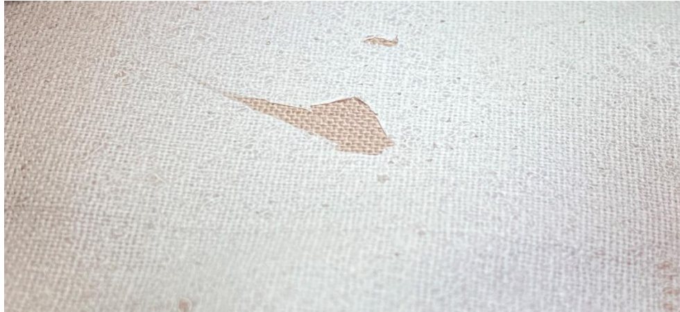
30. ábra: Mechanikai sérülés a szálképzett anyagon
