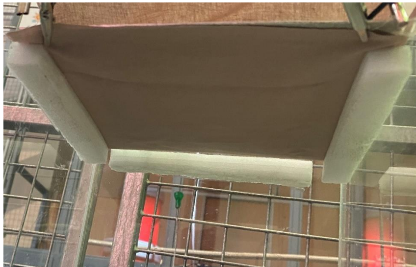
23. ábra: A gyűjtőre rögzített textilanyag a szálképző berendezésben
