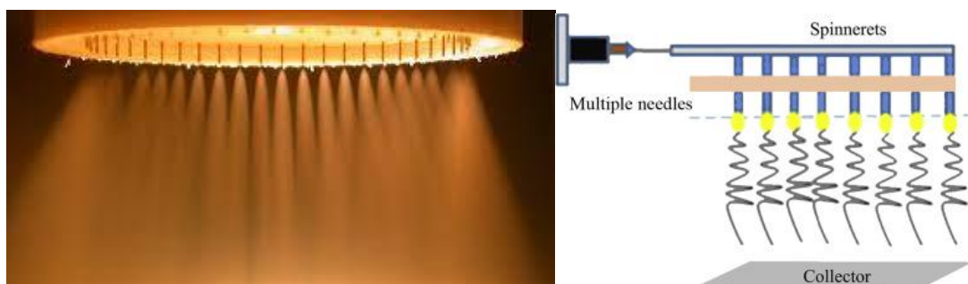
4. ábra: Több tűs elrendezés működése és annak egyszerűsített vázlata [22][23]
