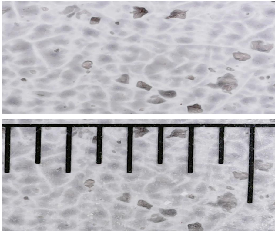
12. ábra: Feszültség hatására keletkezett hibák a rétegben
