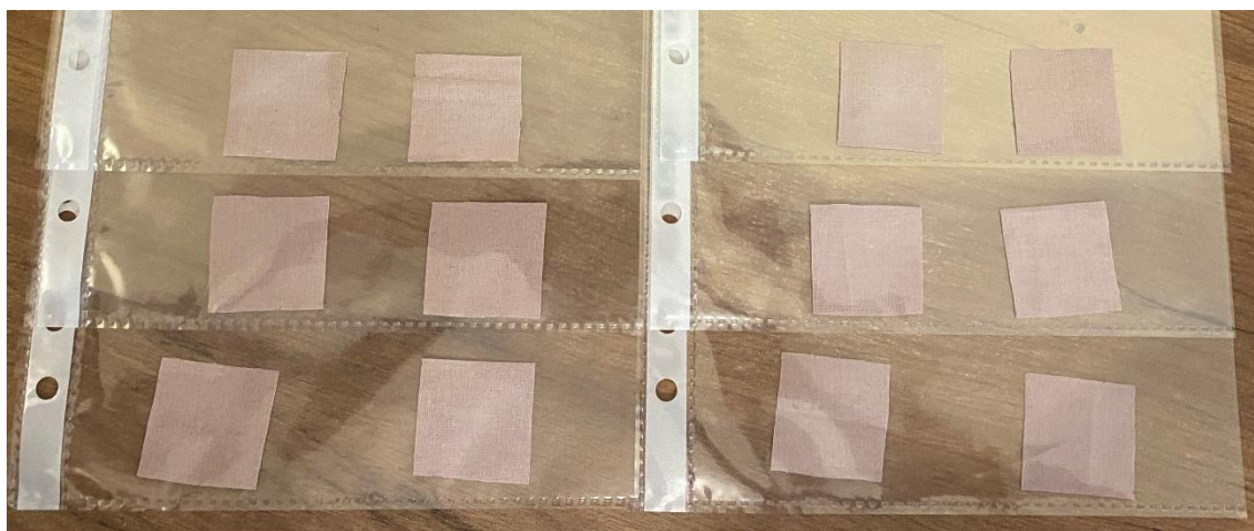
26. ábra: A szűrési hatékonyság vizsgálatára készített minták
