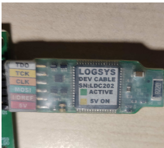
2. ábra. Az LDC202-es sorozatszámú Logsys Download Cable fejlesztői kábel
