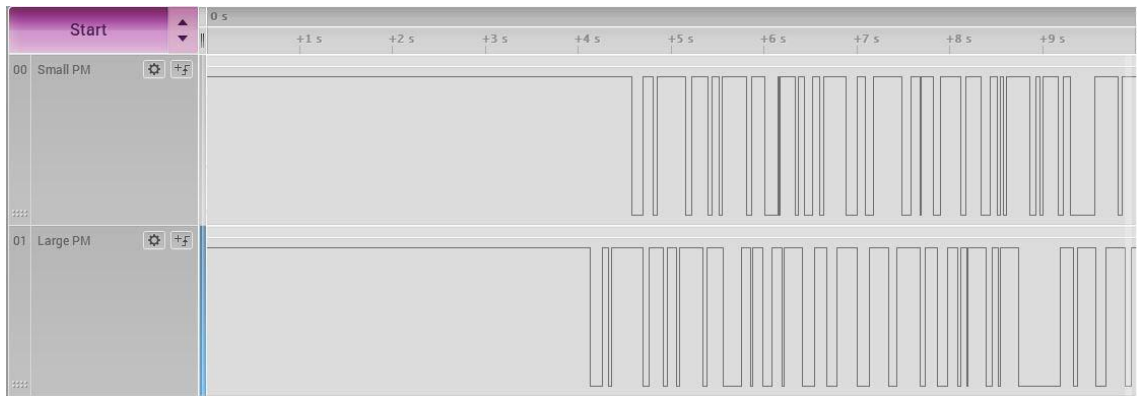
3.12 Ábra: Kézi marógép tisztításának légszennyezése (10 mp-es időintervallumban)
