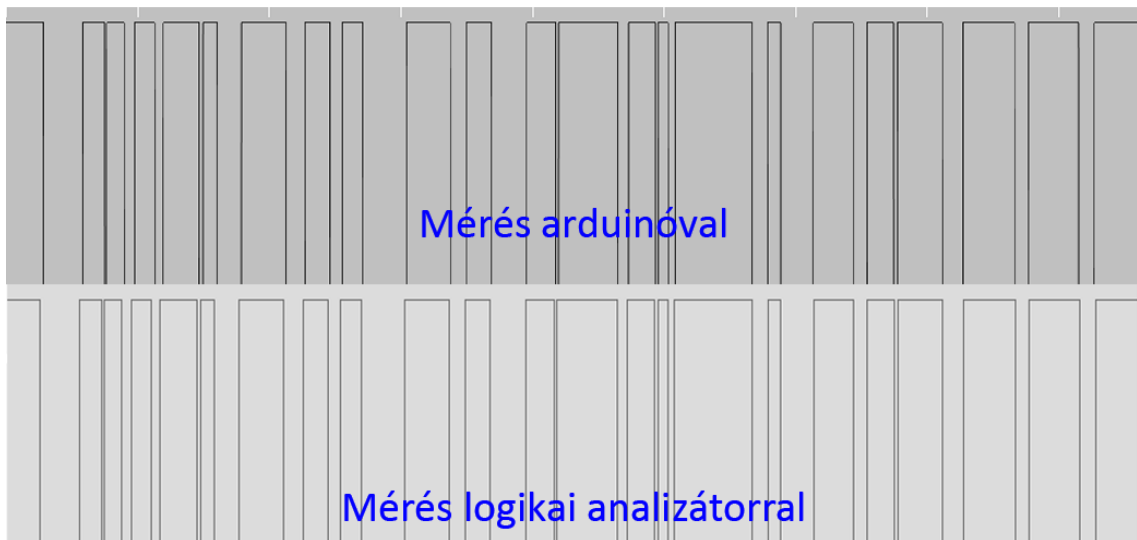
3.6 Ábra: Az Arduino Nano és egy logikai analizátor mérése
