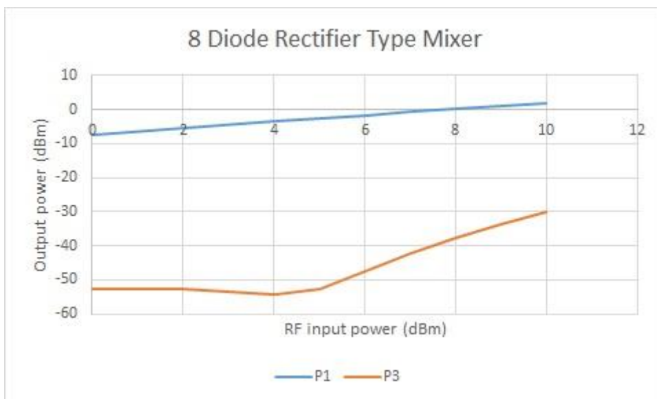
30. ábra. A rectifier típusú keverő bemenő RF teljesítmény- kimeneti teljesítmény karakterisztikája
