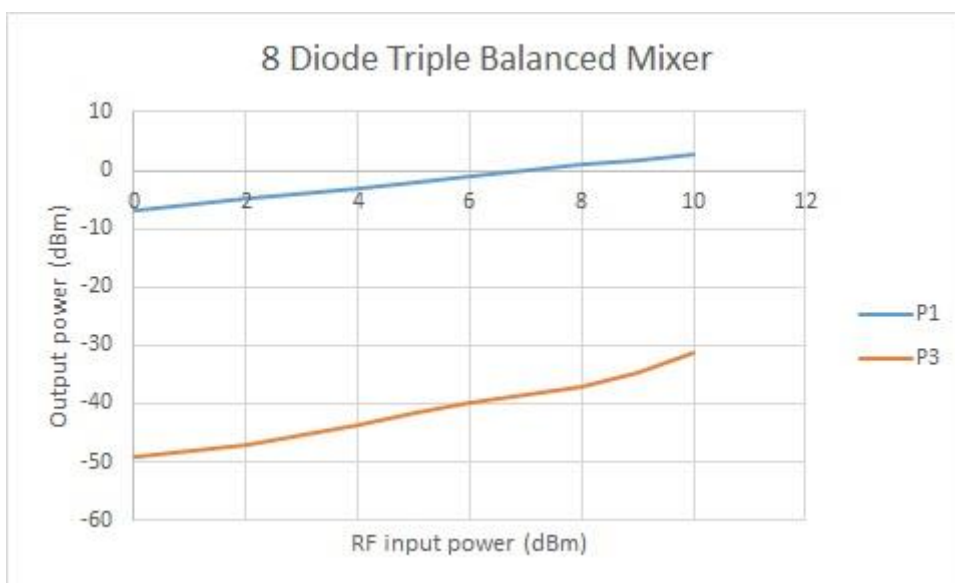
29. ábra. A 8 diódás triple balanced IP3 méréséről készített ábra.
