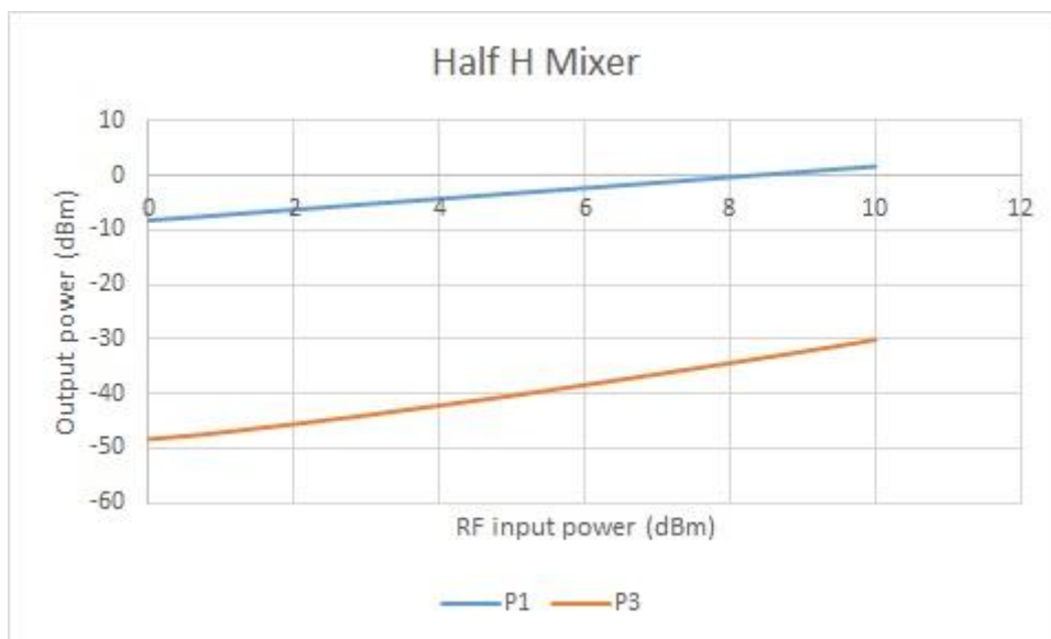
34. ábra. A tranzisztoros half H keverő IP3 mérésakor készített diagramja
