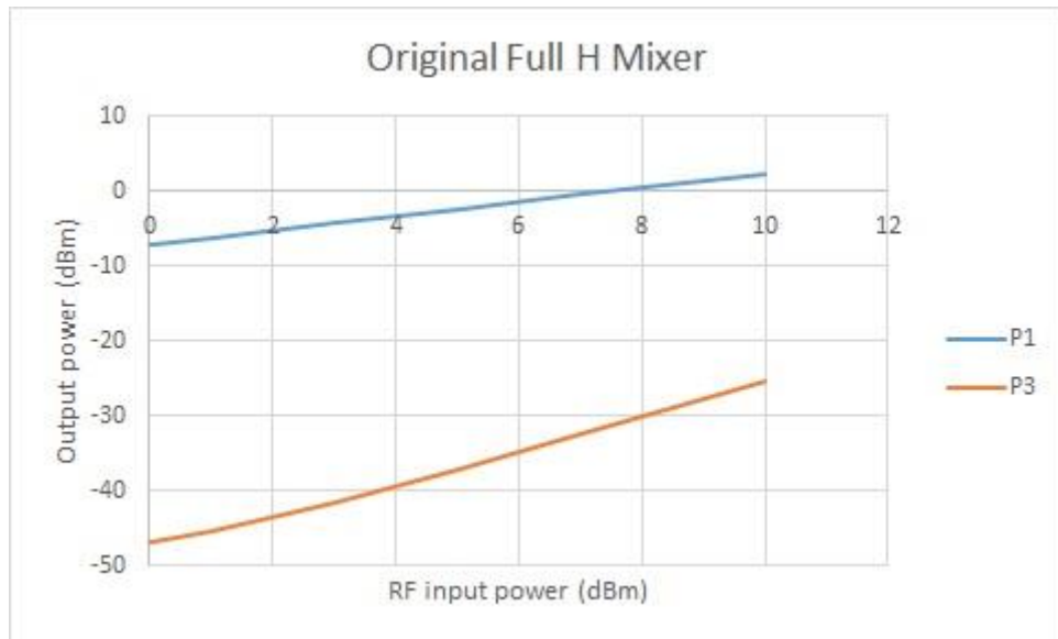
36. ábra. A tranzisztoros H keverő elsőrendű és harmadrendű intermodulációs termékeinek karakterisztikája a bemeneti RF teljesítmény függvényében
