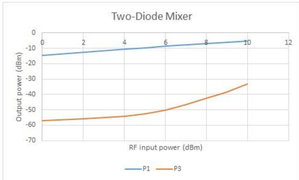
27. ábra. A két-diódás keverő IP3 méréséről készített ábra. A kék görbe a kívánt keveredési termék bemeneti teljesítmény-kimeneti teljesítmény karakterisztikáját, a narancs görbe a harmadrendű intermodulációs termék ugyanezen karakterisztikáját jelöli.
