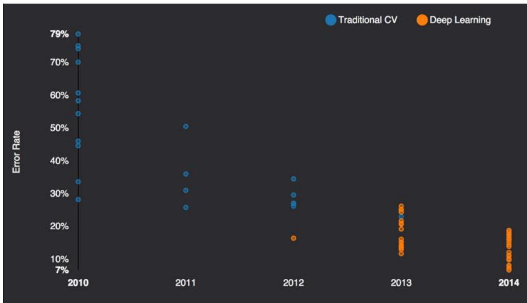
7. ábra: Az ILSVRC versenyen a klasszifikációs hiba javulása 2010-2014 és a Deep architektúrák megjelenése és elterjedése (forrás: Musings on Deep Learning 8 )
