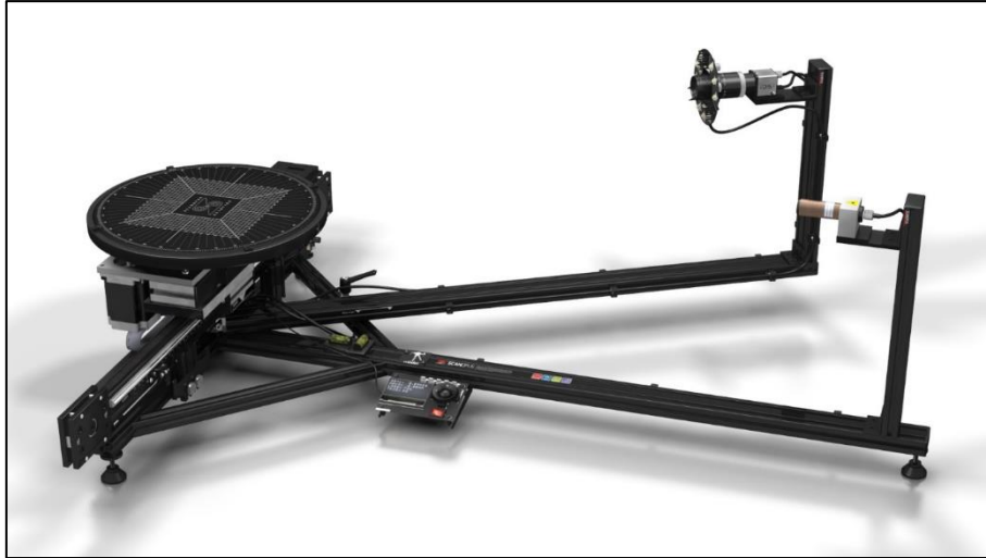
2. ábra: A 3D szkennер, melyen látható a kamera, a lézer, a forgótányér és egy – különböző adatok megjelenítésére képes – LCD kijelző, a kontroller pedig a tálca alatt helyezkedik el
