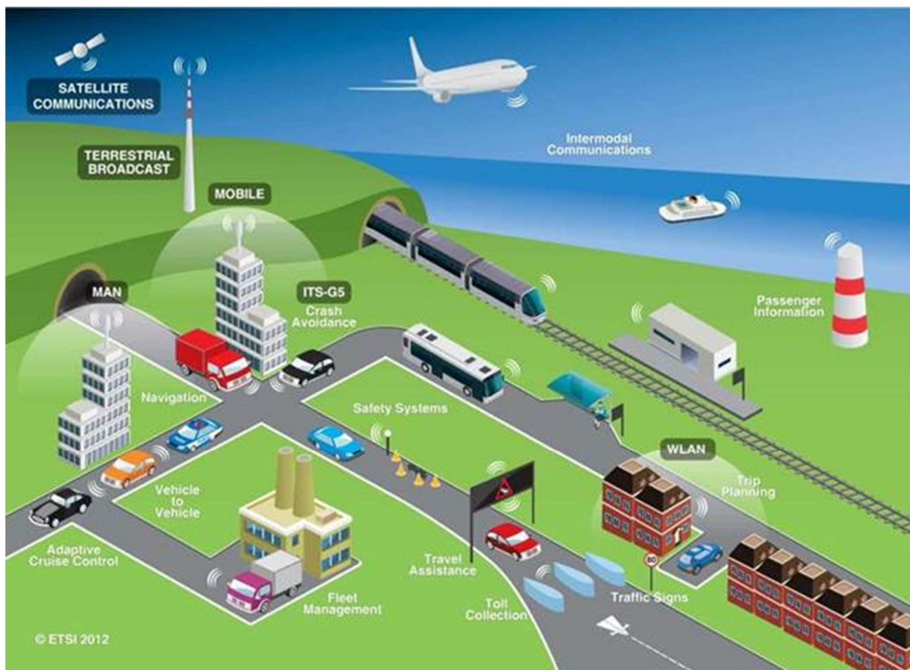
B1. ábra: Kommunikáló felek és néhány alkalmazási lehetőség C-ITS rendszerekben (forrás [B1])
