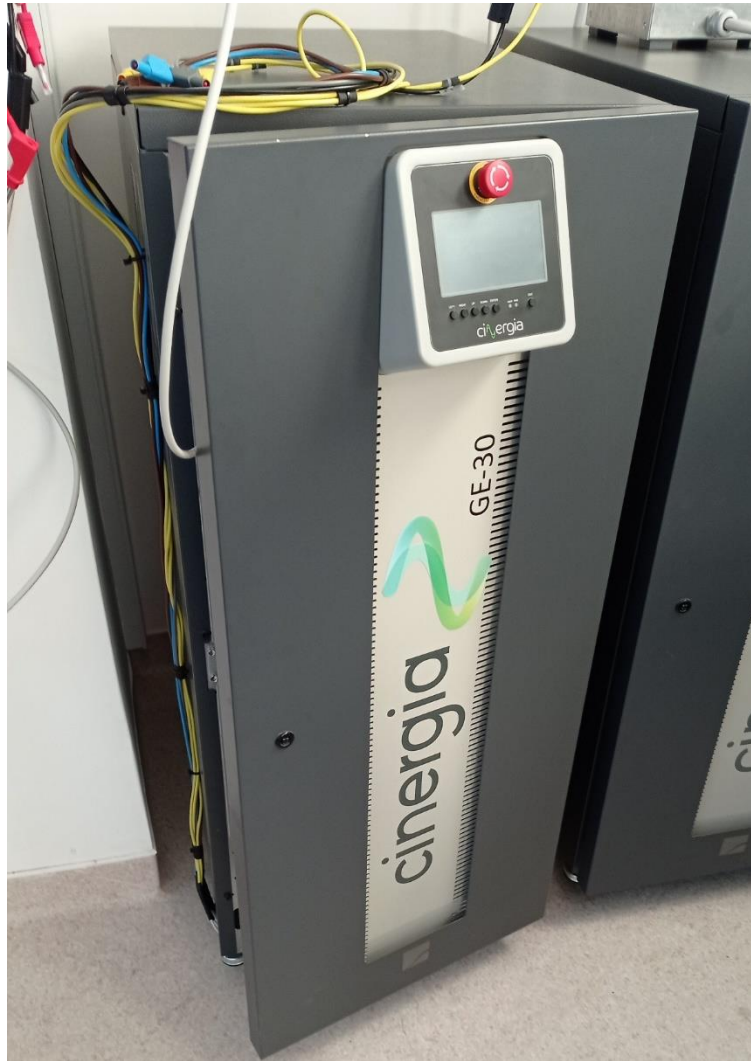
45. ábra: Cinergia GE-30 hálózatemulátor
