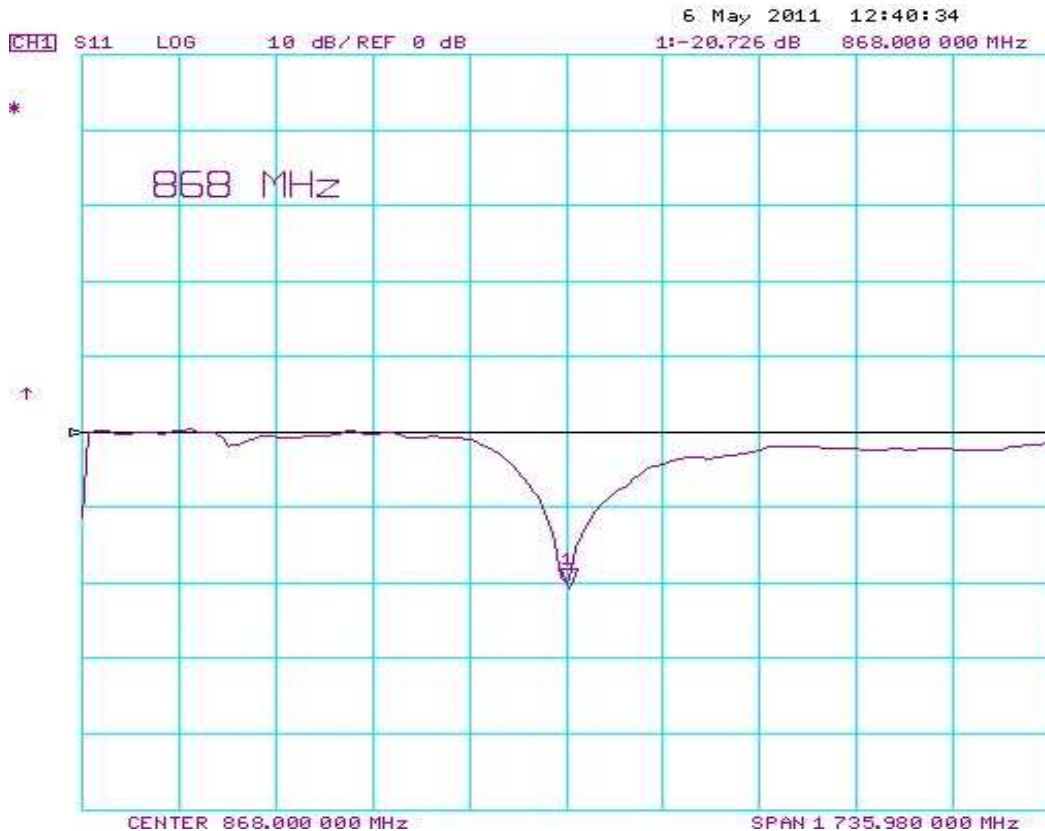
6. ábra: Reflexió mérése VNA-val
