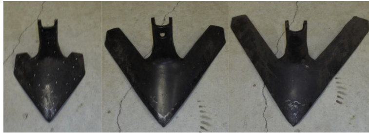
4. ábra. Különböző kultivátorszerszám kialakítások. [3]
