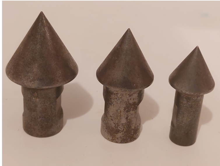
13. ábra. Szabványos 60°-os kúpszöggel rendelkező mérőkúpok penetráció méréséhez balról jobbra: 2\text{cm}^2 , 3,33\text{cm}^2 , 4\text{cm}^2 projektált keresztmetszettel.
