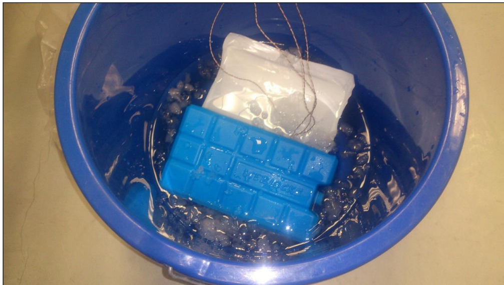
5-4. ábra: 0 °C-os jégfürdő a kalibrációhoz
