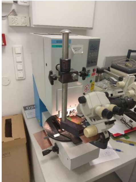
19. ábra: Dage toló és húzó gép az ETT tanszéken
