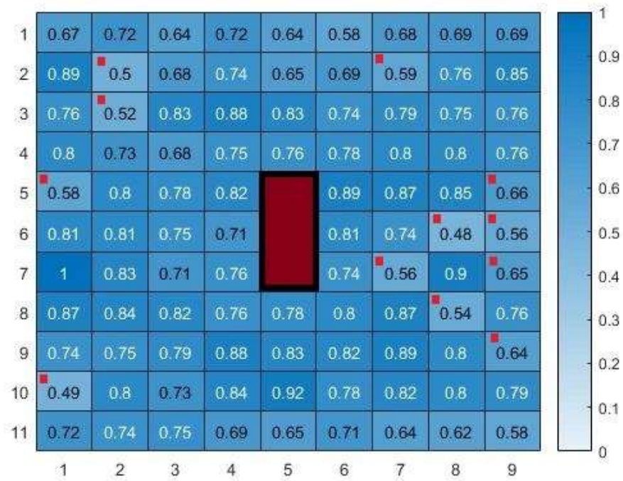
16. ábra: Az 'A' nevű panel nyírási szilárdság mérési eredménye szintérképen, relatív 0-1 értékeléssel.
