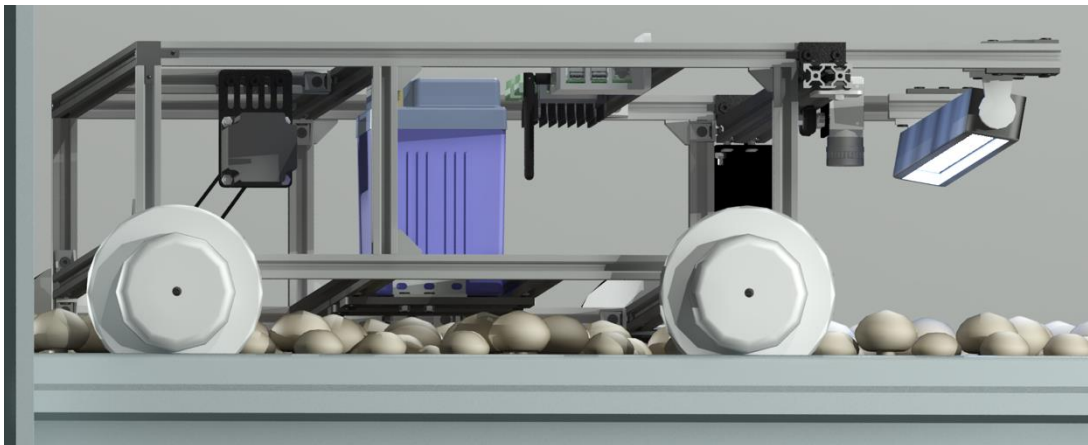
39. ábra: Az adatkommunikáció vezeték nélkül, a tápellátás akkumulátorról történik (saját ábra)
