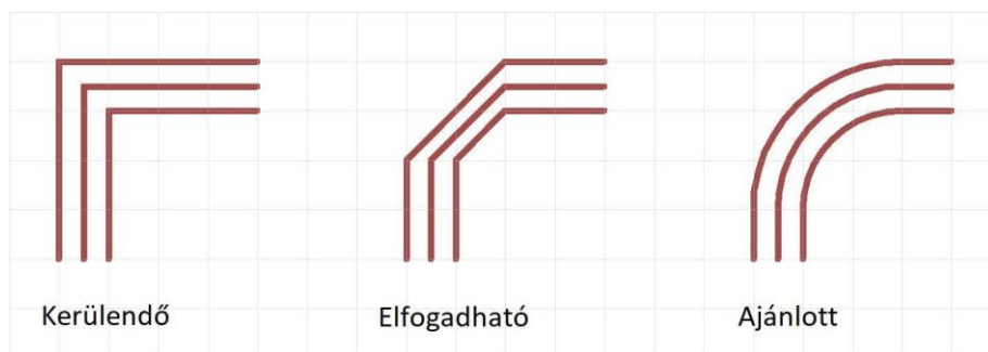
4.2.1 – Hordozók kialakítható vezetékezés típusok
