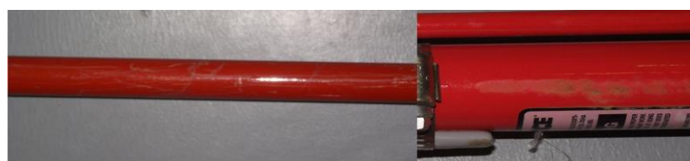
5.8. ábra: Hanyag tárolás következtében megkarcolódott felületű szigetelő rúd
