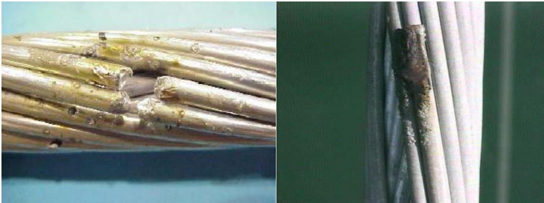
6.4. ábra: éles kiálló részek a sérült vezetón
