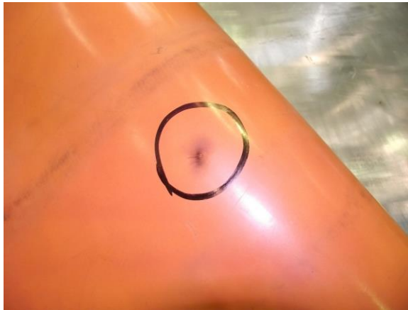
6.19. ábra: Vizsgálat során tönkrement szigetelő lepel
