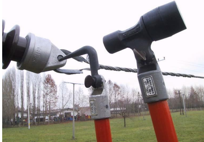
3.1. ábra: Egyetemes rúd végére csatlakoztatott segédszerszámok
