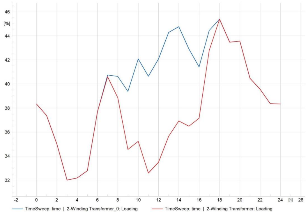
7. ábra: A transzformátor terhelési görbéje eredeti HMKE betáplálás mellett
