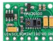
6. ábra MAX30100 típusú pulzoximéter önálló chipként és a hozzá tartozó áramkör
