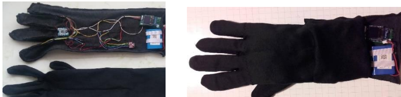
16. ábra: Az elkészült hardver-prototípus, a kesztyűbe varrva
