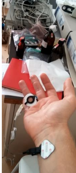
33. ábra: Iontroforézis segítségével a szövetekbe lokálisan bejuttatott acetilkolin segítségével verejtékezés váltható ki. Ez a bőr vezetőképességének megváltozásával jár, így a bőrimpedanciamérő működése ellenőrizhető, finomhangolása elvégezhető.
