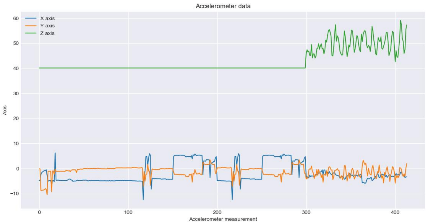
36. ábra Egy „szimulált” ujjremegés során végzett minta mérés eredményei a gyorsulásérzékelő X, Y és Z tengelyeiről
