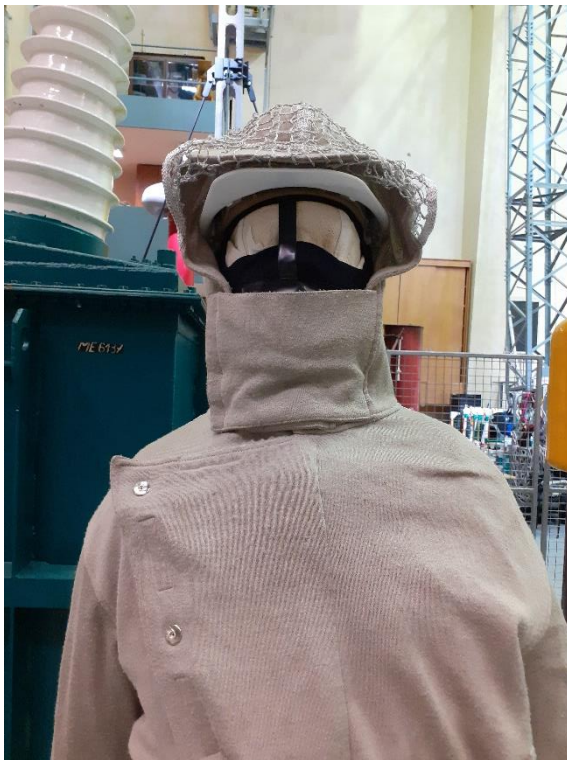
20. Ábra - Archáló mérés (fent)
