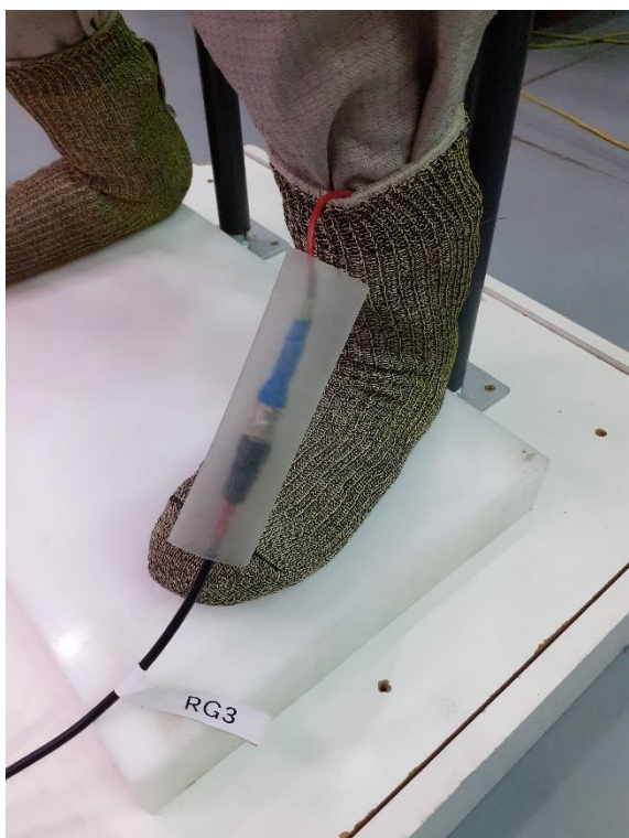
27. Ábra - Testáram csatlakozó kint, szigetelésben
