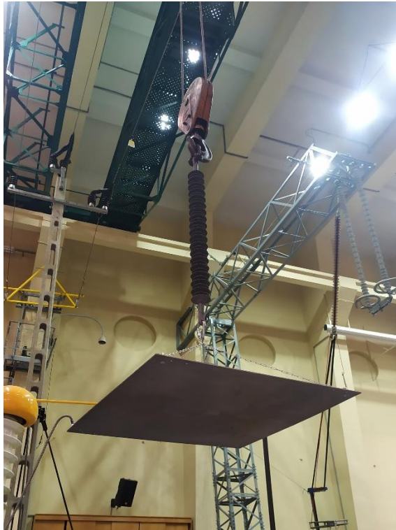
5. Ábra – A mérésekhez használt síkeletród és platform
