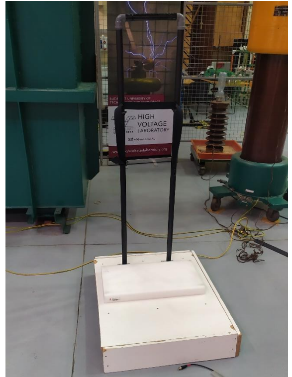
5. Ábra – A mérésekhez használt síkeletród és platform
