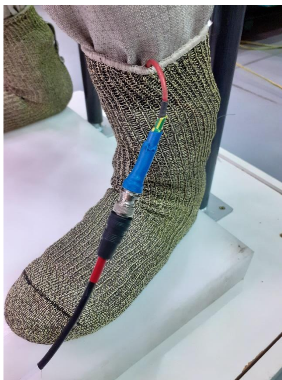
28. Ábra - Testáram csatlakozó kint, szigetelés nélkül
