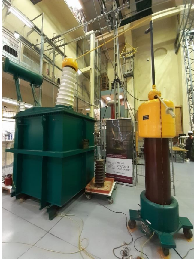
3. Ábra - 250kV Ganz transzformátor és az 1:20000 osztású kapacitív feszültségosztó
