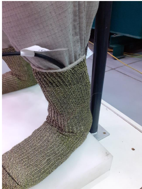
24. Ábra - Testáram csatlakozó zokniban
