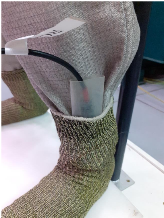
25. Ábra - Testáram csatlakozó félig a zokniban
