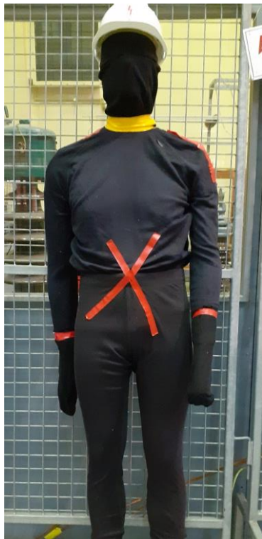
13. Ábra – „E” próbababa alumínium fólia vezetővel rajta
