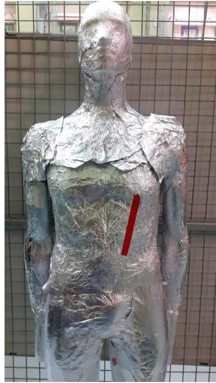
13. Ábra – „E” próbababa alumínium fólia vezetővel rajta
