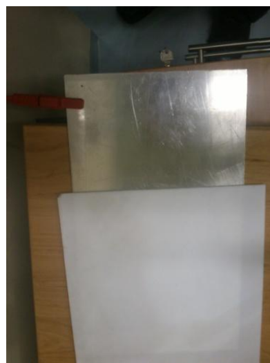
6. ábra . Mozgatható fémlap (baloldalon), földelt fémlap a teflon szigetelőlappal (jobb oldalon)
