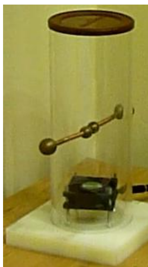
5. ábra Plexi cső az elektródákkal és ventilátorral
