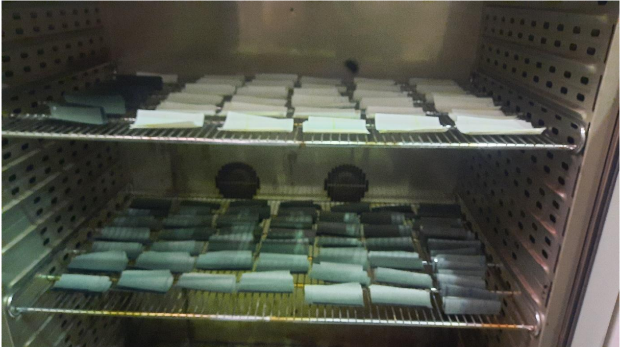
14. ábra: Szigetelőpapír minták az öregítő kemencében
