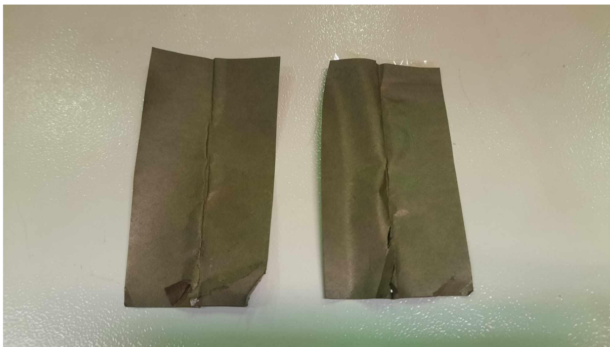
16. ábra: DC feszültség alatt átütött, öregített triflexil minták
