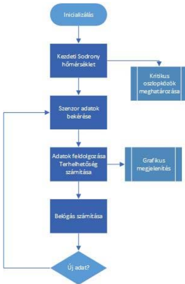
17. ábra A program egyszerűsített működése
