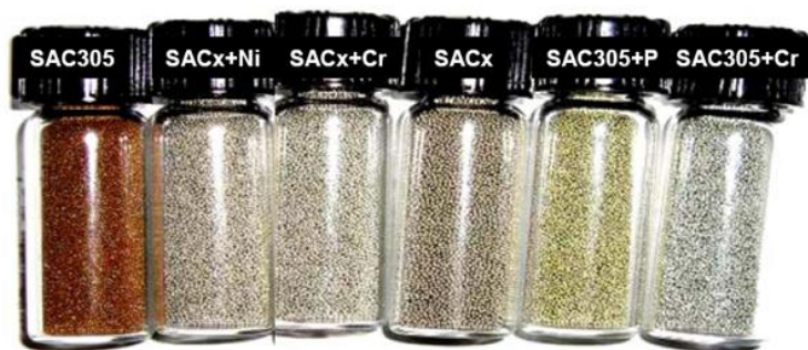
14. ábra Különböző mikroötvözőket tartalmazó forraszok színe öregítés után [6]
